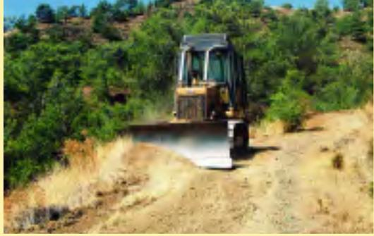
κατά τη διάρκεια του καλοκαιριού ένας αριθμός από τα τρακτέρ αυτά αποσύρεται από τις άλλες εργασίες και απασχολείται αποκλειστικά με την κατασκευή έργων πρόληψης και καταστολής πυρκαγιών, όπως τη διάνοιξη και συντήρηση αντιπυρικών λωρίδων. Πολλά δε από τα τρακτέρ αυτά κατά τα Σαββατοκύριακα και τις δημόσιες αργίες μεταφέρονται σε σημεία φόρτωσης ή βρίσκονται φορτωμένα σε φορτηγά οχήματα του Τμήματος, έτοιμα να μεταφερθούν, χωρίς καθυστέρηση, στους τόπους τυχόν πυρκαγιών.
